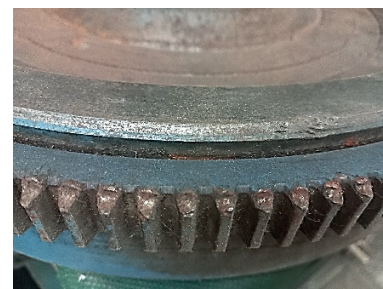
в) износ, деформация зубьев зубчатого венца
