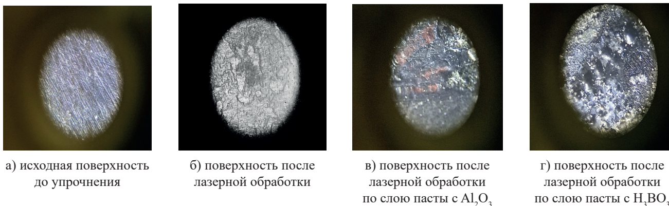
Рисунок 1 – Поверхности образцов до и после упрочнения (увеличение \times 125 раз)
