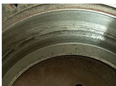
а) износ поверхности контакта с ведомым диском сцепления
