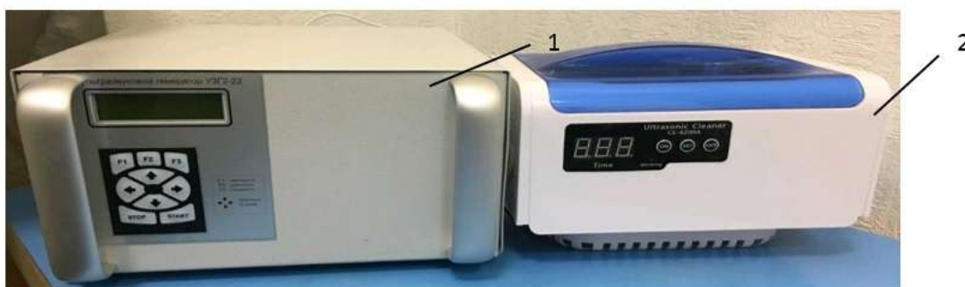
Рисунок 2– Лабораторная установка исследования ультразвукового воздействия на семена ячменя: 1 – ультразвуковой генератор УЗГ-2К; 2 – ультразвуковая ванна
