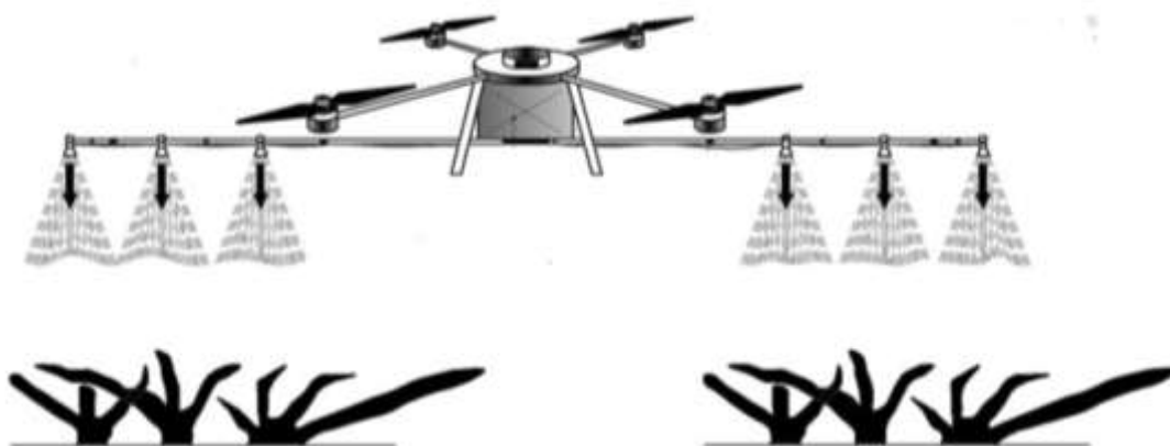
Рисунок 2 – Сельскохозяйственный БПЛА, который осуществляет опрыскивание в вертикальном направлении (сверху вниз)
