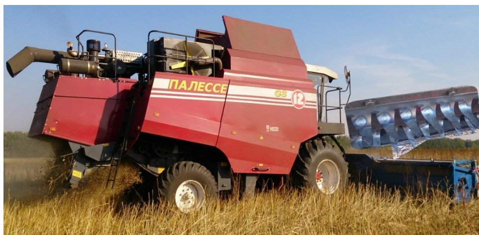
Рисунок 3 – Уборка смешанных посевов очесывающей жаткой «Озон»
