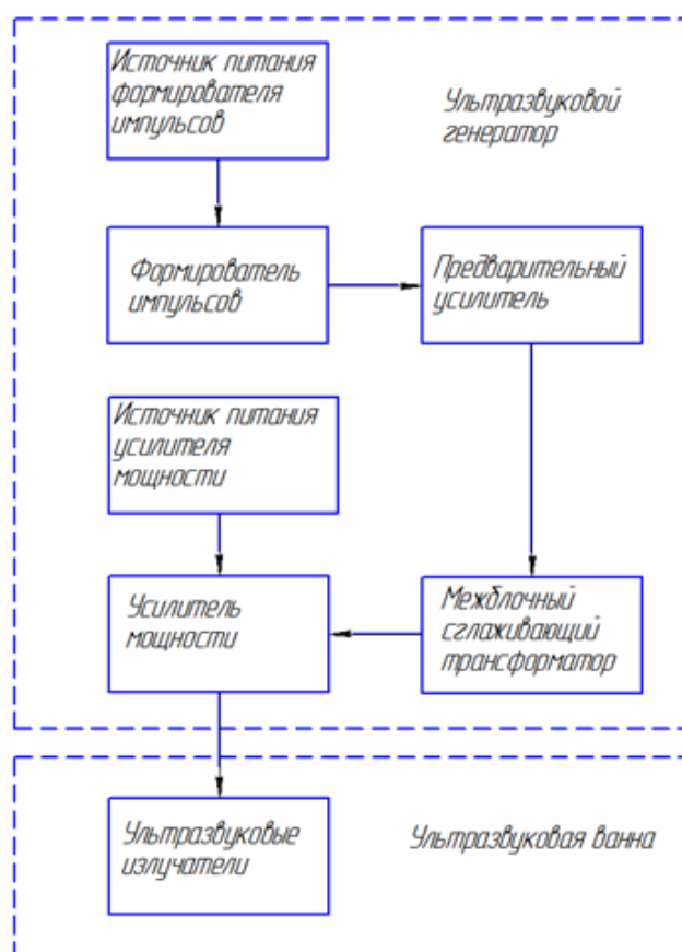
Рисунок 2 - Ультразвуковое устройство предпосевной обработки семян
