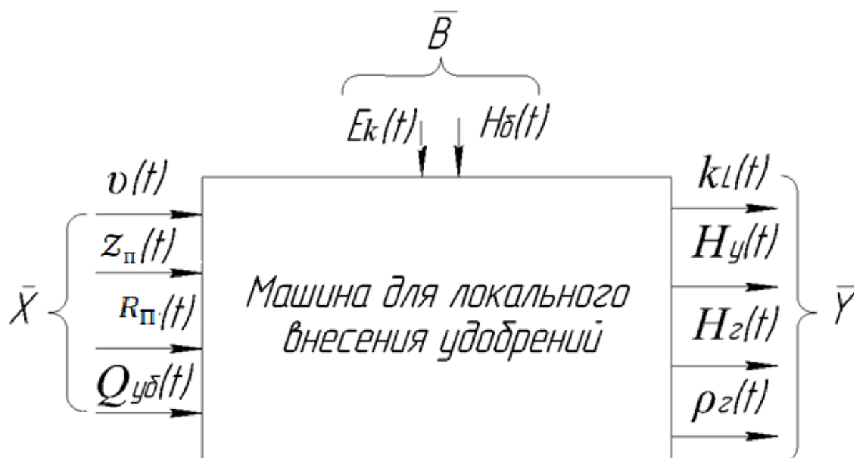
Рисунок 2 - Информационная (общая) модель машины для локального внесения органических удобрений:
