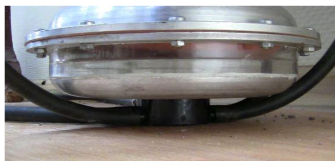
Рисунок 3 – Коллектор экспериментального доильного аппарата (верхнее положение мембраны)
