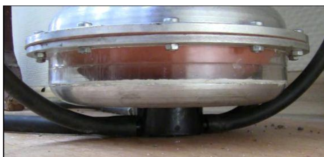
Рисунок 2 – Коллектор экспериментального доильного аппарата (нижнее положение мембраны)
