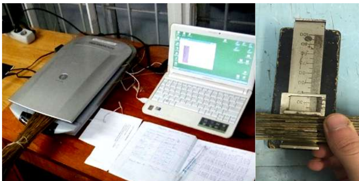
Рисунок 2 – Аппаратура для контроля координат цветности и горстевой длины стеблей (А – сканер и ЭВМ для определения координат цветности; Б – замер диаметра стеблей льна)
