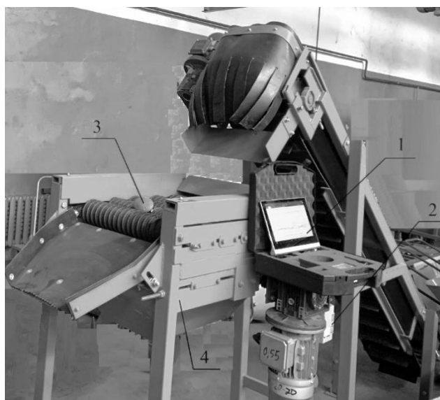
Рисунок 3 – Общий вид лабораторной установки по определению места и уровня повреждений корнеплодов и лука:
