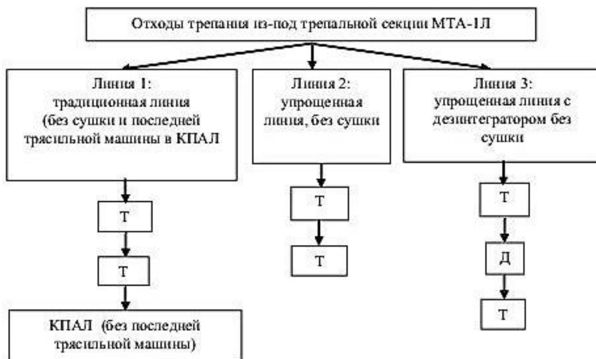
Рисунок 1 – Схема эксперимента по изучению различного состава технологического оборудования для переработки отходов трепания льна-долгунца в короткое волокно:
