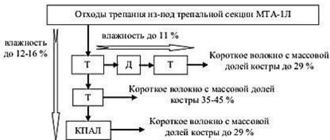
Рисунок 3 – Предлагаемое технологическое оборудование для производства короткого льноволокна без подсушки отходов трепания:
