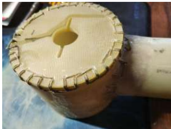
Рисунок 9 – Внешний вид соединения стенки с корпусом цилиндра трансформатора
