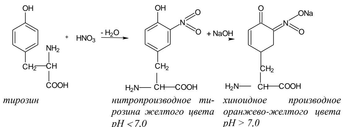
Ход работы: К раствору белка 1 мл прилить 5-6 капель концентрированной азотной кислоты, белок выпадает в осадок. При подогревании (осторожно) раствор окрашивается в желтый цвет. После охлаждения в пробирку наливают по каплям 10% раствор едкого натра до появления оранжевого окрашивания вследствие образования натриевой соли динитроти罗зина.
