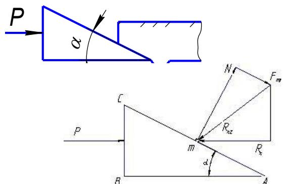
3. Обозначьте на схеме угол трения почвы о рабочую поверхность плоского клина
