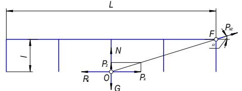
25. Необходимая скорость  $u$  (м/с) питающего транспортера кузовного разбрасывателя органических удобрений РОУ-6 в зависимости от заданной нормы внесения  $Q$  ( $\text{кг}/\text{м}^2$ ) рассчитывается по формуле: (использовать расчетную схему)
